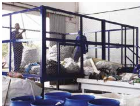
Investimento em estruturas para reciclagem: cesto para deposição de resíduos e ampliação de área de triagem
